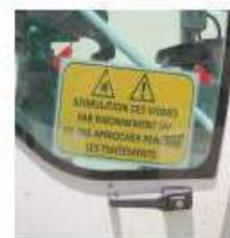
Il existe un risque de brûlure en cas d'exposition aux UV, d'où l'importance pour le chauffeur d'avoir un pare-brise qui filtre les rayons UV.
